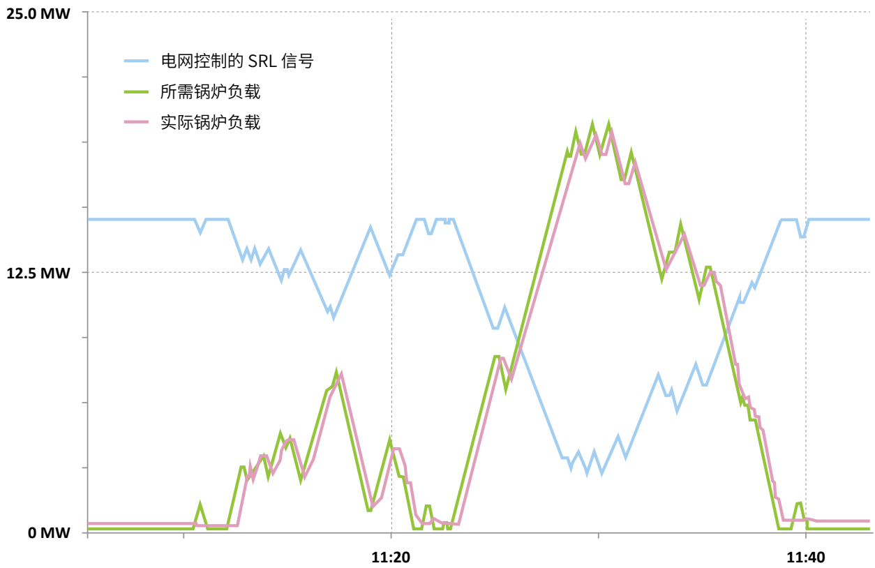
法兰克福 Infracore Höchst 公司的典型 SRL 调节曲线。
